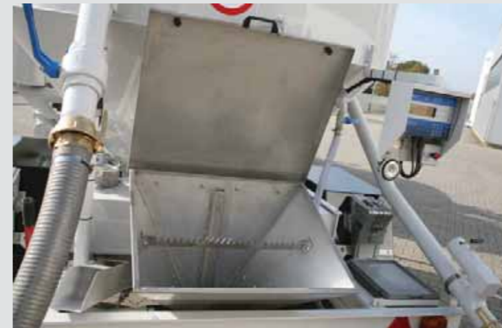
Feststoffkomponentenbehälter aus VA, für Sackware. Stainless steel bucket for solid components, for bagged cargo.
