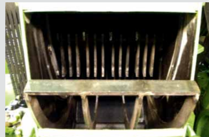
Hammerwerk mit 72 Widiaschlägern. Siebrahmen für Drahtsiebe in 10 verschiedenen Größen. 380 mm breit / Ø 800 mm.
