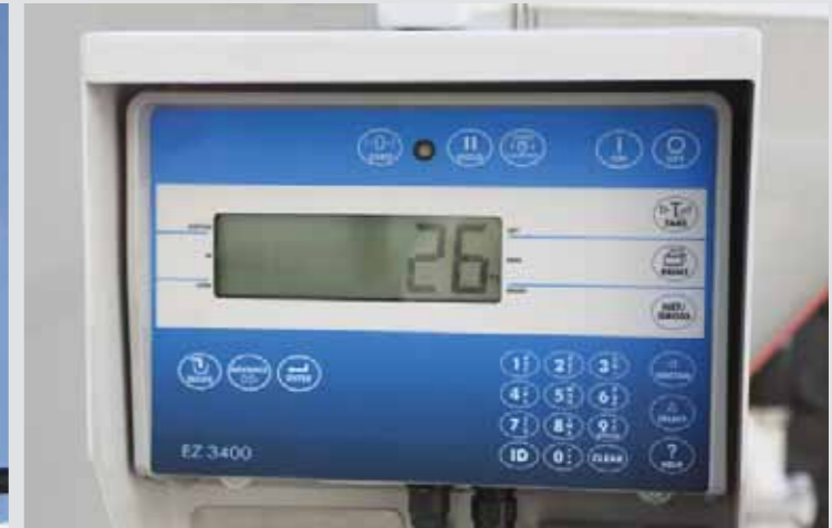
Mischcomputer für 99 verschiedene Mischungen mit jeweils 99 Komponenten. Mixing computer for 99 different composites with 99 components each.
