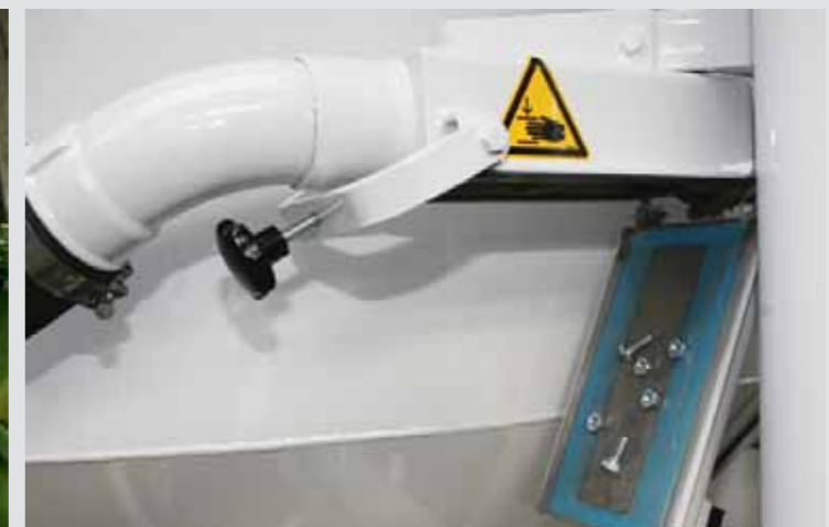
Magnet im Ansaugtrakt zur Abscheidung von Metallpartikeln. Magnet in intake part to separate metal particles.
