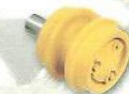
Roți motoare sau coroane dințate LIS. Roți conduceătoare cu dispozitiv de pretenzionare pentru excavatoare.
