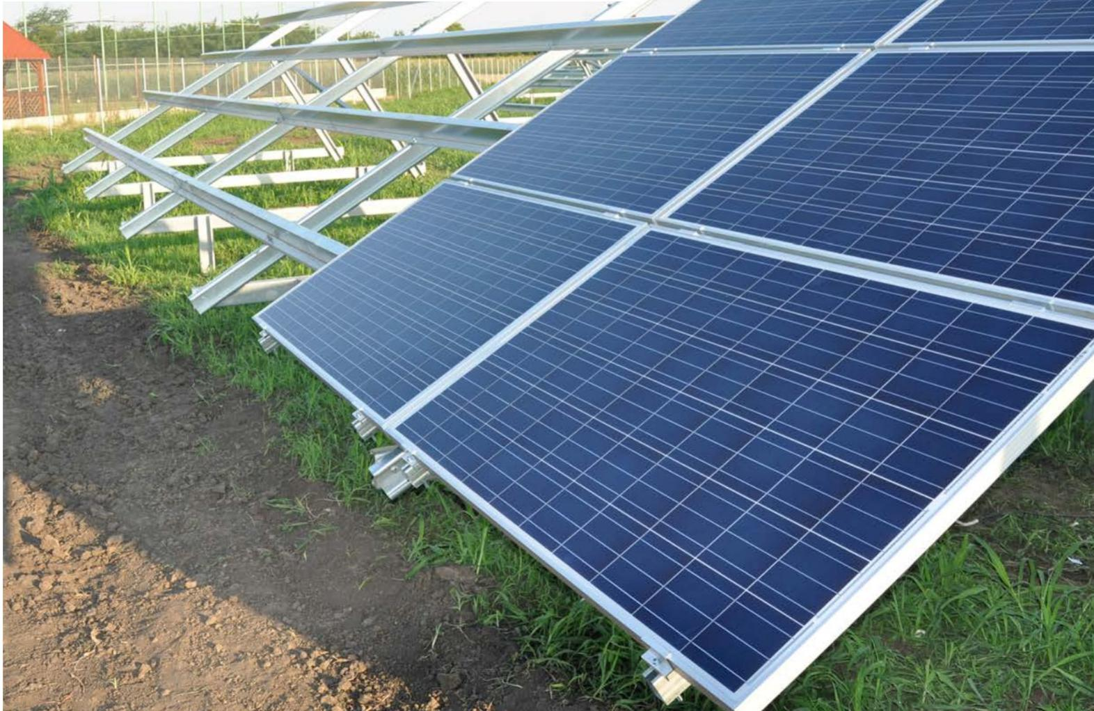
Structura metalica zincata cu stalpi batuti in sol. Este posibil a fi montata si pe portiuni cu denivelari. Incarcare la zapada de 200-250 kg/m<sup>2</sup>, vant 130 km/h si seism pana la 0,26g.
