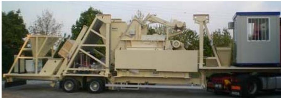
Structura din otel proiectata pentru a sustine buncarul de material inerte, sistemele de dozare si malaxorul.
