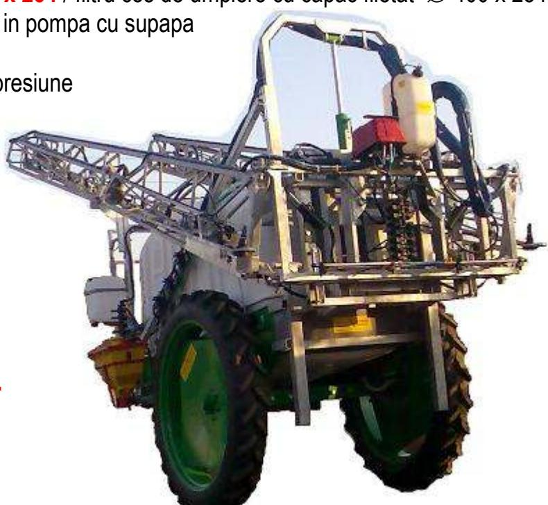
**Extra price for tri jets and air injection nozzles.** / 36 – 42 - 48 portduze simple cu atac rapid, teava inox, duzekematal cu injectie de aer, cu antipicurator cu membrana si filtru duza;
