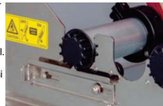
Frana pentru material situata pe suportul media.
