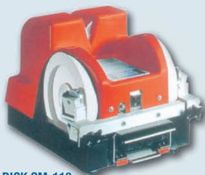
DICK SM-110 Macchina per affilare e sbavare coltelli velocemente ed a regola d'arte, con raffreddamento ad acqua. La macchina dispone di magneti che garantiscono un'affilatura assolutamente sicura ed un preciso angolo di affilatura. Toglie la bava è semplice, grazie al movimento opposto delle ruote superiori.
