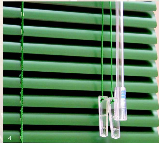
**SOLARIS Classic25** face parte din clasa jaluzelor sigure "SAFE BLINDS", prevenind accidentele prin strangulare cu ajutorul **mecanismul intelligent de declipsare a snurului de ridicare**. Atunci cand un corp prins intre atele de ridicare se lasa prin propria greutate peste butonul terminal al acestuia, cele doua parti componente se declipseaza lasand corpul sa alunece liber in jos (figura 4), prevenind posibilitatea unei strangulari accidentale.
