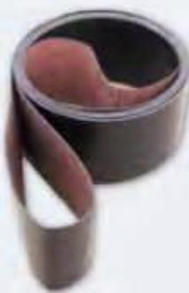
În funcție de tipul transmisiei (dreapta sau în cruce), se pot fabrica cu fețe textile, cauciucate sau mixte.
