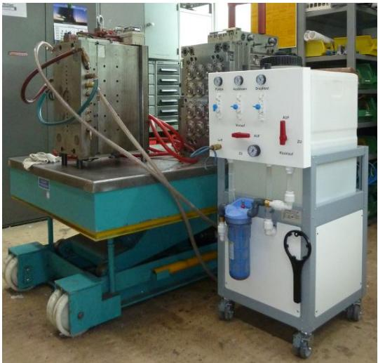
"Acest echipament a scazut temperatura uleiului din masina de injectie de la 59.5°C la 45°C. A rezultat o functionare silentioasa si nu au mai aparut nici un fel de defectiuni "
