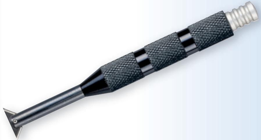
Lames avec 2 jeux d'arêtes de coupe pour l'ébavurage à droite ou à gauche, en poussant ou en tirant. Une simple pression sur le bouton-poussoir fait basculer la lame pour l'insérer ou la retirer du trou à usiner. Clé 6 pans insérée dans le bouton-poussoir, pour le changement des lames.
