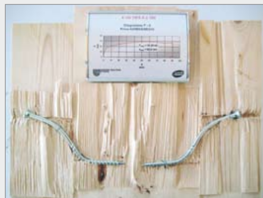
Rezultate experimentale la o conexiune realizată cu șuruburi HBS solicate la tăiere la Universitatea din Trento
