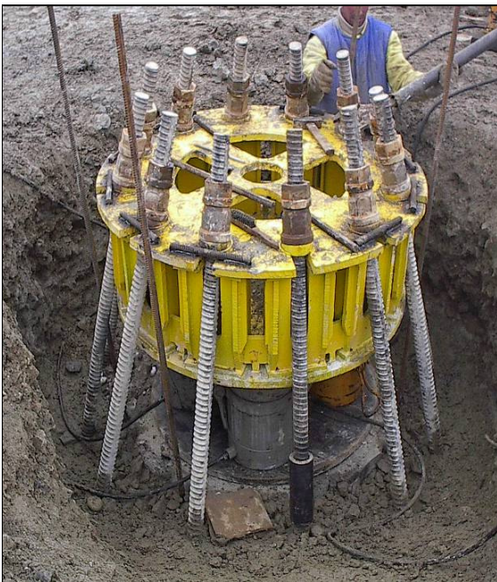
Teste de capacitate portanta la compresiune cu sarcini pana la 14000KN
