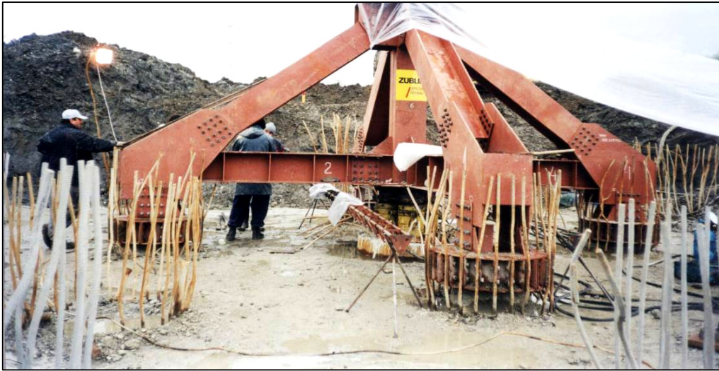
Teste de capacitate portanta la compresiune cu sarcini pana la 14000KN
