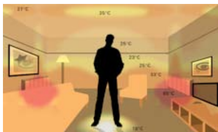
Distribuția temperaturii cu utilizarea unui sistem de încălzire convențional prin calorifere. În încăpere există diferențe mari de temperatură (18 - 65°C).
