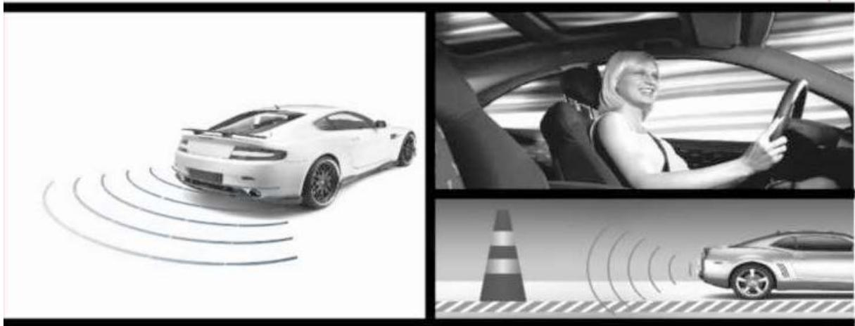
**PNI Escort E4** este compus din 4 senzori cu ultrasunete si unitatea centrala. Acest sistem detecteaza distanta dintre masina si obstacolul din spate prin senzorii cu ultrasunete, instalati la bara de protectie din spate. Conducatorul auto poate aprecia distanta si sa poata evita un posibil accident.
