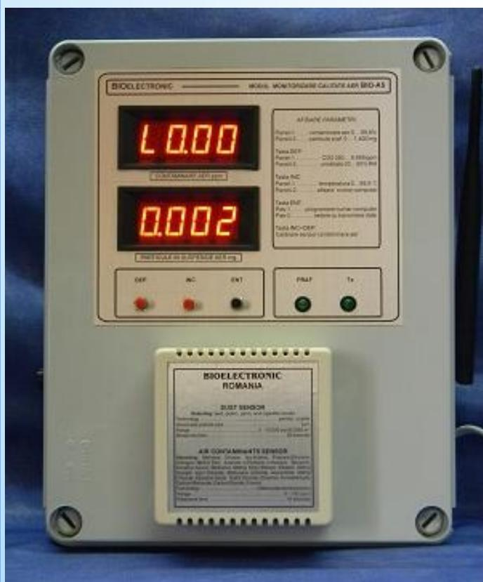
Modul pentru masurare parametrii calitate aer si transmisie date la chemare de catre master
