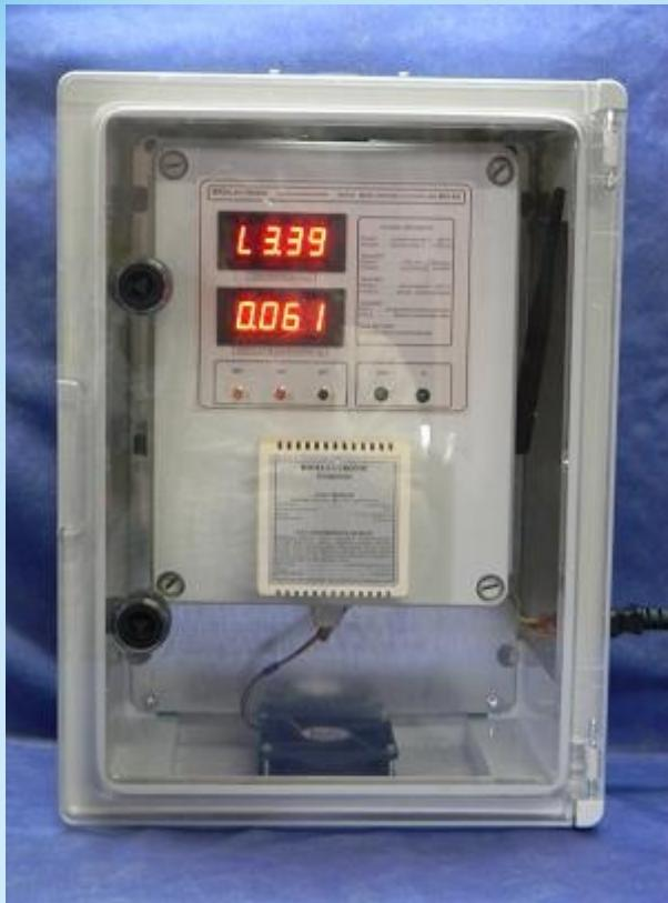
Modulul pentru masurare poate fi construit si in varianta protejata conform foto alaturat. In acest sistem aerul pentru analizat este introdus fortat de un ventilator amplasat in partea de jos a incintei. Imprimanta termica amplasata pe panoul frontal tipareste datele masuratorilor la stare de alarma sau programat la intervale prestabilite. Datele se pot tipari si la cerere pe incinta selectata sau pe toate incintele monitorizate.
