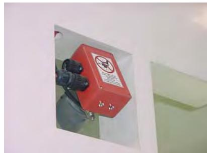
Senzor de detectie flacara, ampalsat pe o cabina ColorMax<sup>3</sup> cu schimbare rapida de culoare.
