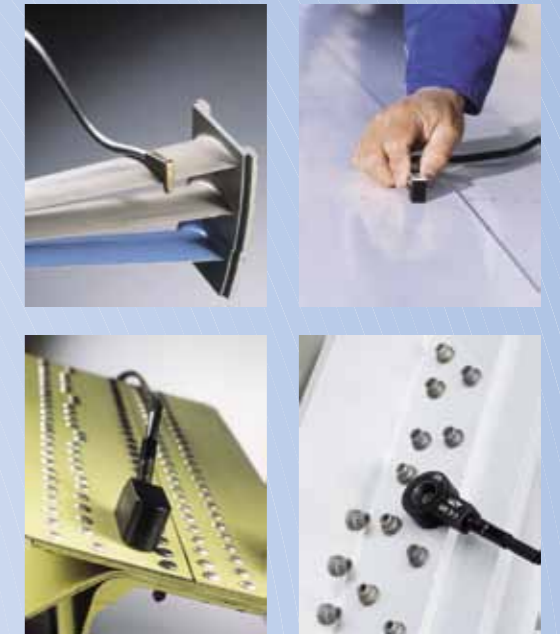
Das ELOTEST M2 V3 ermöglicht alle Arten von Handprüfungen. Von der Hochfrequenz-Oberflächenprüfung an hochlegierten Bauteilen über mittelfrequente Riss- und Korrosionsprüfungen bis zu niederfrequenten Untersuchungen mehrlageriger Strukturen auf Spannungsrisse.
