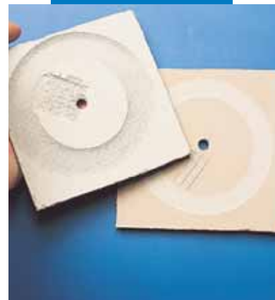
Test de abraziune Taber dupa 200 de cicluri, executat pe sapa autonivelanta Ultraplan (mostra din dreapta) si pe o sapa autonivelanta normala (mostra din stanga)
