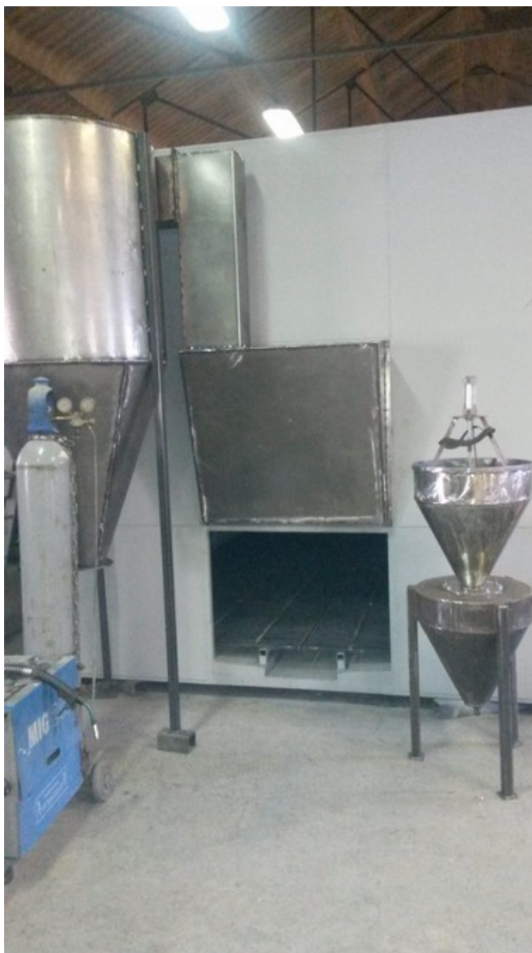
9. Cabină cu accesul sablorului din interior, vedere din spate
