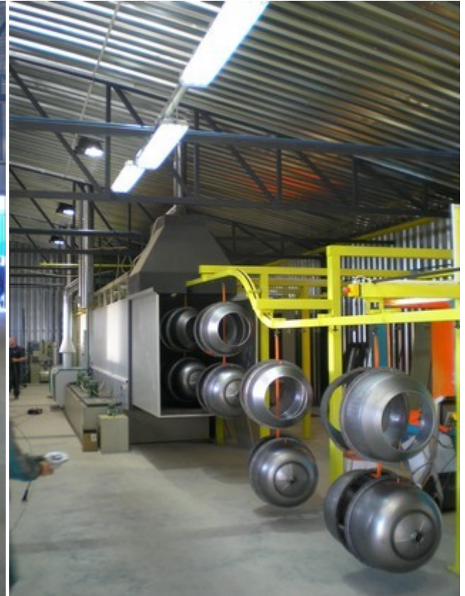
2. Zonă de încărcare și intrare în cabina de degresare-fosfatare
