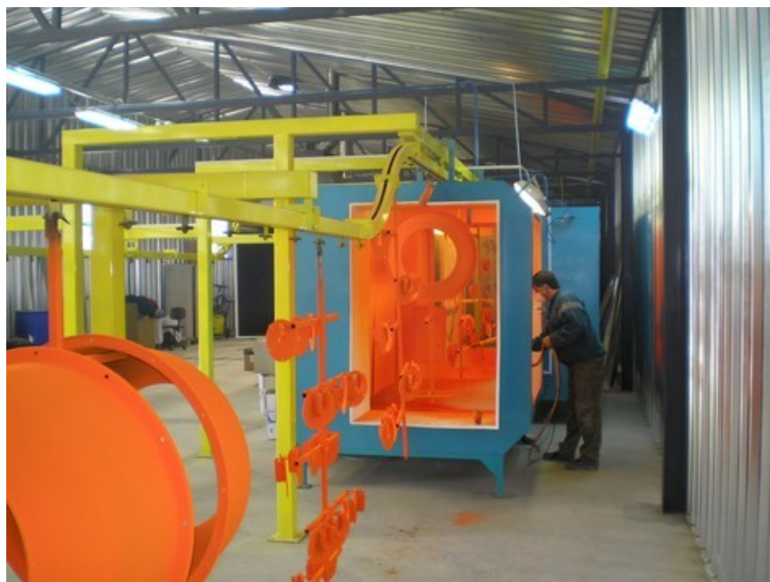
3. Ieșire din cabina de vopsire electrostatică cu pulbere
