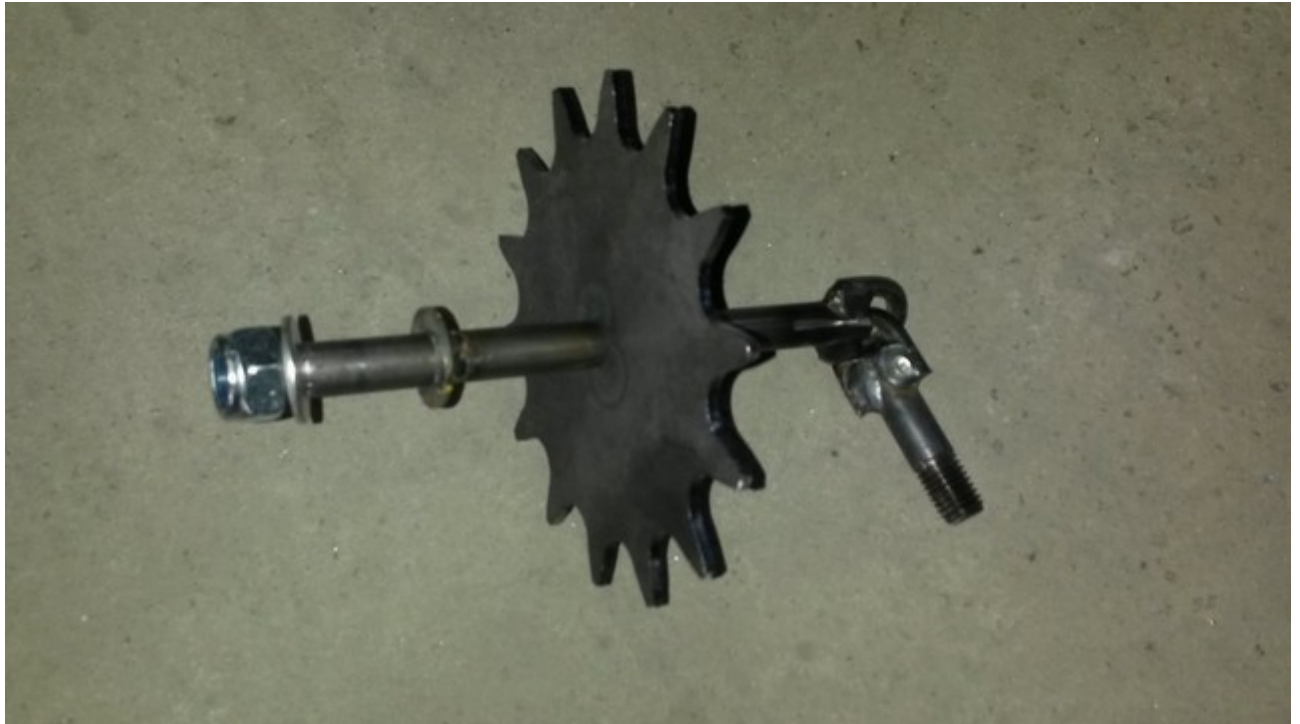
21. Piesele sunt rotite în zona de vopsire prin sistem cremalieră - roată dințată
