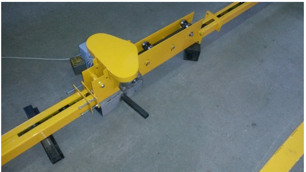
11. Sistem de angrenare: motor electric Anti-Ex și reducție
