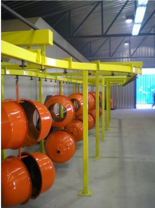
1. Zonă de răcire după ieșirea din cuptorul de polimerizare
