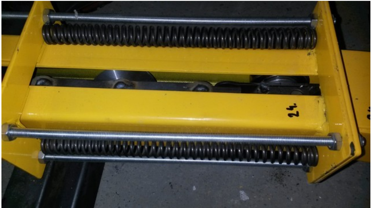
10. Segment mobil pentru tensionarea lanțului cu 4 arcuri
