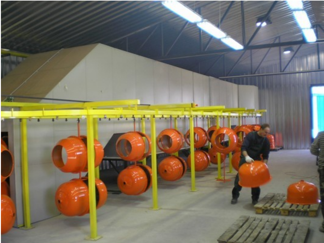
4. Zonă de răcire după polimerizare și descărcare piese
