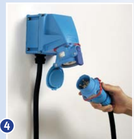
4 Acum ștecherul și priza sunt separate, contactul accidental cu componentele sub tensiune fiind împiedicat fie printr-un disc rotativ de siguranță (DS, DSN), fie prin clasa de protecție IP4X (DB), resp. IP2X (DN).
