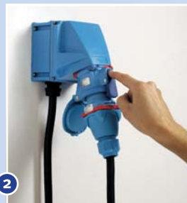
2 O simplă apăsare a butonului de pe clema de decuplare întrerupe circuitul electric, ștecherul sare în poziția sa de repaus și este susținut în baionetă.
