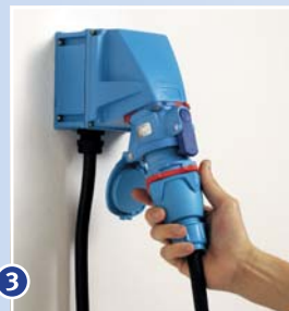
3 Ștecherul poate fi extras acum în condiții de siguranță deplină; pentru aceasta rotăți-l cu un sfert de rotație spre stânga (modelul DS, DSN, DB), resp. spre dreapta (modelul DN).
