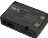
**FMB640** - echipament profesional dedicat autocamioanelor de orice tip, care prin intermediul CAN-ului incorporat oferă toată gama de informații de la bordul mașinii și de asemenea se poate conecta și Sonda Litrometrică pentru a avea controlul total asupra camionului.
