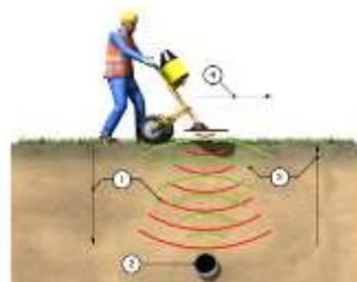
Propagandu-se in mediul, undele sunt reflectate sau difractate de catre interfetele care limiteaza structurile cu caracteristici electromagnetice contrastante si sunt remise spre suprafata, unde sunt captate de antena, apoi inregistrate, in functie de timp. Masuratorile sunt realizate continuu sau punct cu punct de-a lungul profilelor.
