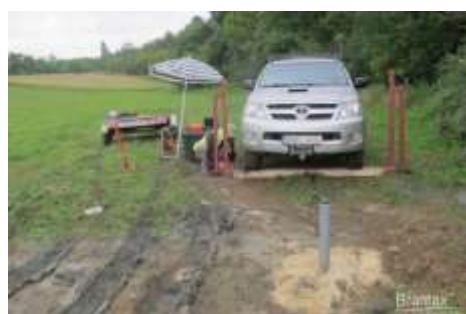
Acesta metoda seismică presupune existența a cel puțin două foraje destinate acestui tip de investigații. Acestea investigații seismice pot pune în evidență foarte bine stratificata și caracteristicile stratelor geologice aflate între cele două foraje.
