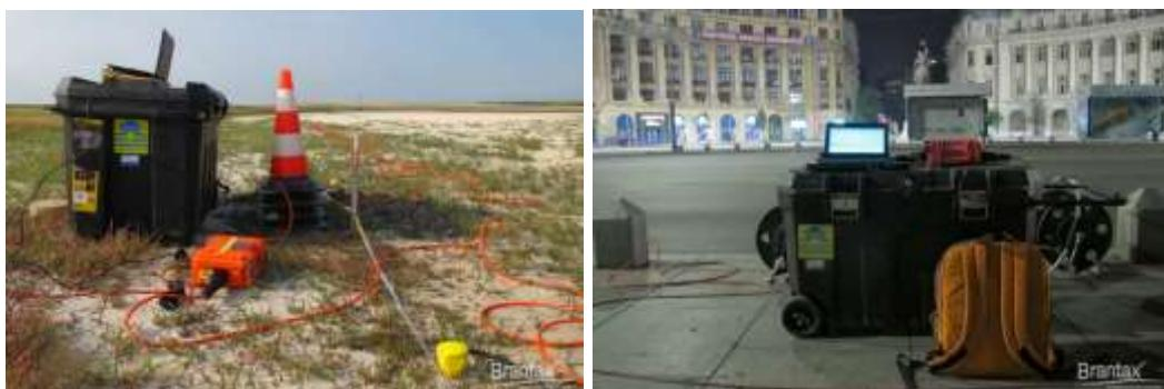
*Nota: Metoda este aplicabila pe teren ce permite amplasarea geofonilor si generarea undelor seismice. Spre deosebire de alte metode seismice metoda MASW este aplicabila cu succes si in medii urbane, unde exista un zgomot seismic permanent.*
