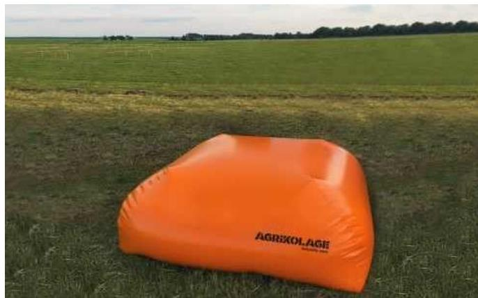
Perna de apa din PVC pentru depozitare lichide. Este produsa din material PVC 630 gr/m<sup>2</sup>, cu rezistenta UV. Este prevazuta cu valve de admisie pentru intrare si evacuare. Se poate utiliza pentru apa de ploaie, irrigatii, ingrasaminte lichide (UAN) sau deseuri lichide.
