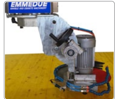
Inclinare manuala a capului de taiere 0° a 90° Manual tilting head from 0° to 90°
