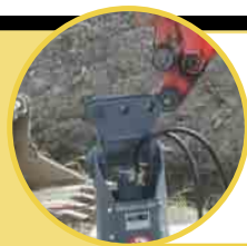
Testata con doppio snodo e blocco per fori orizzontali Double joint head with locking system for horizontal holes
