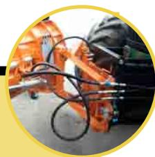
Sollevatore idraulico a parallelogramma
