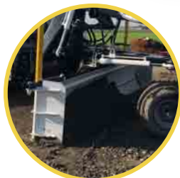
Flap laterali con posionamento meccanico su 3 diverse gradazioni e banda superiore imbullonata per aumento capacità della lama ( accessori a richiesta ) Side flaps with 3 different position mechanical set up and top trip to increase the blade capacity (options upon request)
