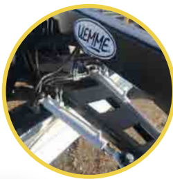
Sistema di rotazione della lama livellante con doppio cilindro idraulico Levelling blade rotation system with double hy- draulic cylinder
