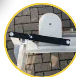
Piastre porta pali di supporto per ricevitori segnale laser imbullonate sulla lama livellante Poles support plates for laser signal receivers bolted on the levelling blade
