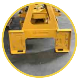
Piastre di aggancio imbullonate al telaio Linkage plates bolted to the frame
