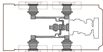
I motoriduttori, rispetto alla tradizionale trasmissione a catena soggetta a frequenti interventi di manutenzione e riparazione, hanno numerosi vantaggi quali elevata velocità di trasferimento (11.5 Km/h), una omogenea distribuzione della potenza direttamente sulle ruote a favore della spinta, una maggiore sensibilità nei movimenti, la vantaggiosa possibilità di lavorare all'occorrenza montando pneumatici vecchi e nuovi dallo stesso lato senza compromettere l'affidabilità della macchina.
