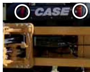
Fari stradali posteriori montabili sugli stabilizzatori durante i trasferimenti e sulla cabina durante lo scavo, per la massima visibilità e protezione
