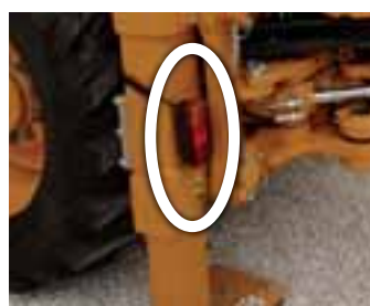
Fari stradali posteriori montabili sugli stabilizzatori durante i trasferimenti e sulla cabina durante lo scavo, per la massima visibilità e protezione
