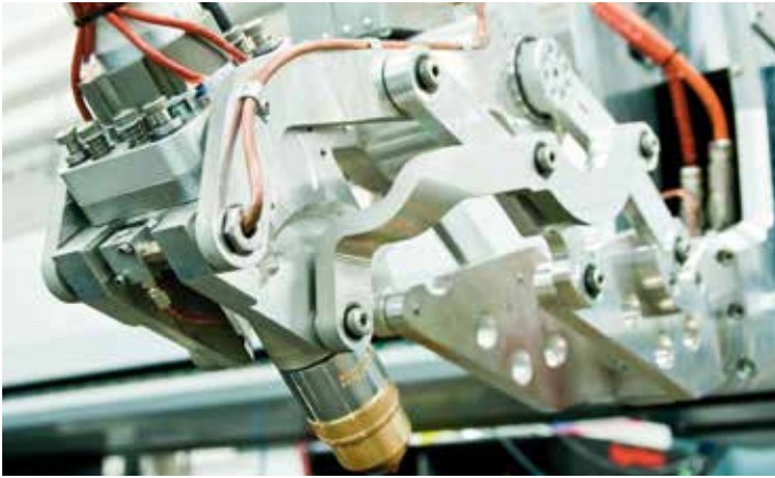
Testa taglio smusso 5 assi plasma • 5 axis plasma level head
