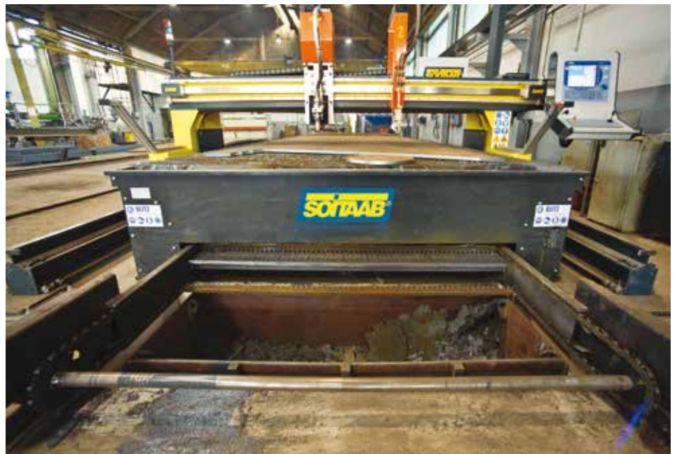
Banco con raschiatore • Scrap conveyor
