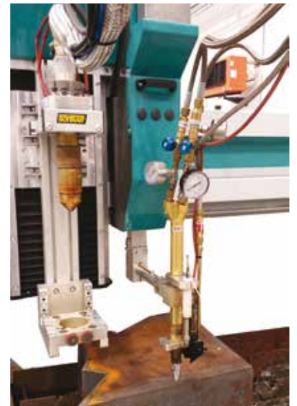
Carrello Doppio supporto plasma ossitaglio • Duo Torch holder plasma and flame
