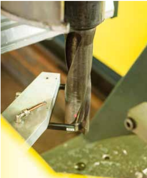
Laser controllo utensili • Laser tools check
