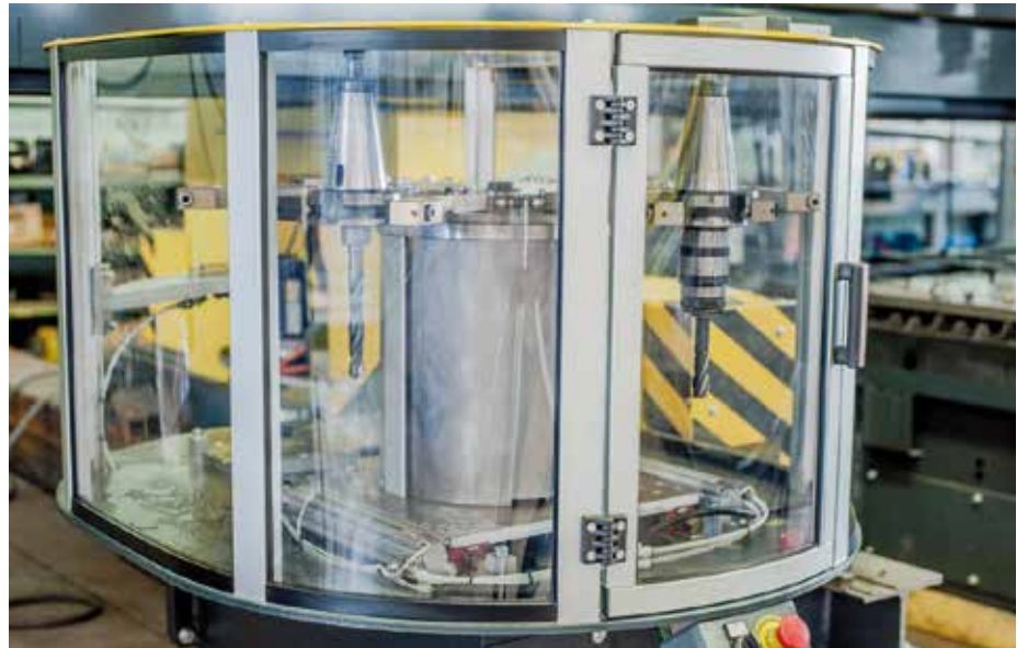
Cambio automatico utensili • Automatic changing tools
