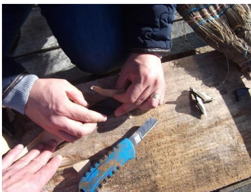
Fig. 8 -Imbinarea dintre doua capete se realizeaza la un unghi de 45 de grade.
