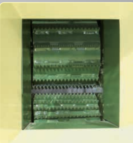
Rulli idraulici auto-allineanti Self-aligning hydraulic rollers Rouleaux hydrauliques auto-alignants Rodillos hidráulicos autoalineables Zelfuitlijpende hydraulische aanvoertrollen Гидравлически приводимы автовыворавливаемых ролика втягивания
