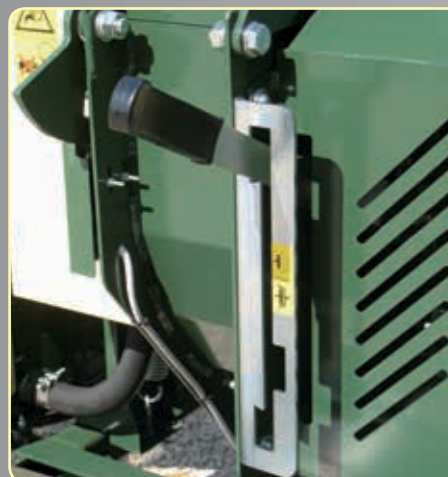
Trasmissione a cinghie con innesto a leva (versioni diesel) Belt transmission with switch lever (diesel engine versions) Transmission par courroies avec embrayage manuel (versions diesel) Transmission por correas con embrague manual (versiones diesel) Riemenantrieb mit Handzuschaltung (Versionen mit Dieselmotor) Riemoverbrenging met inschakeling door hefboom (diesel versies) Трансмиссия с рычагом сцепления (дизельной версии)
