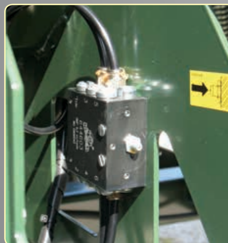
Sistema di lubrificazione dei cuscinetti System for bearings' lubrication Système de lubrification pour coussinets Sistema de lubrificación para cojinetes Abschmiersystem für Läger Smeersysteem van de lagers Система смазывания подшипников
