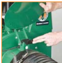
Safety Disconnect automatisches Abschalten des Motors
