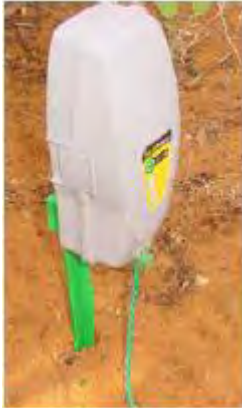
Figura 1.37 Strângeți urechile de pe ambele părți pentru a scoate capacul
