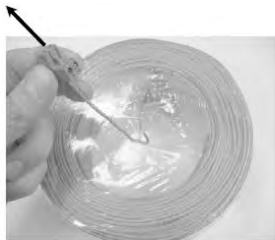
Figura 1.11 – Trageți cablul din învelișul de plastic – nu îndepărtați învelișul, este conceput ca distribuitor.
