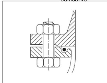
Fig. 2 Bride dotée d'une surface d'appui lisse.
