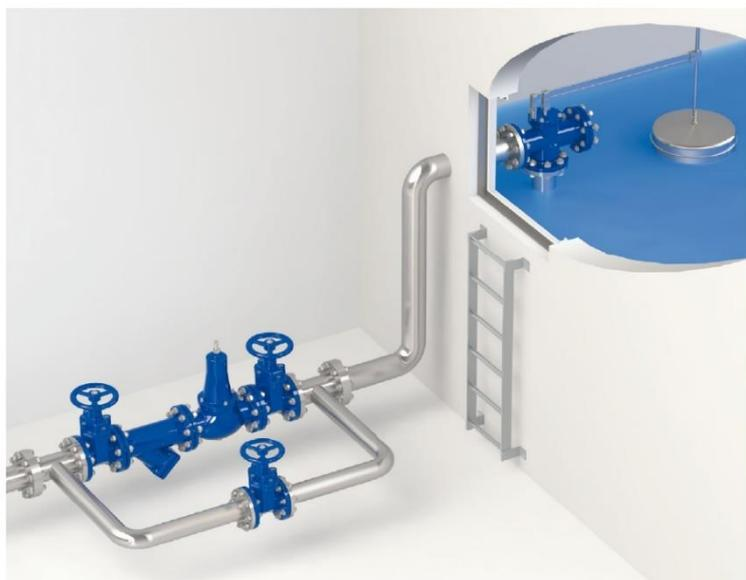
S'assurer que le perçage de la conduite d'arrivée correspond au PN et DN du robinet
